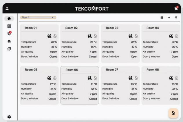
Il sistema è costituito da un Gateway multiprotocollo, abbinabile ad una serie specifica di dispositivi e sensori, e da una piattaforma di monitoraggio Software con relativa APP.
